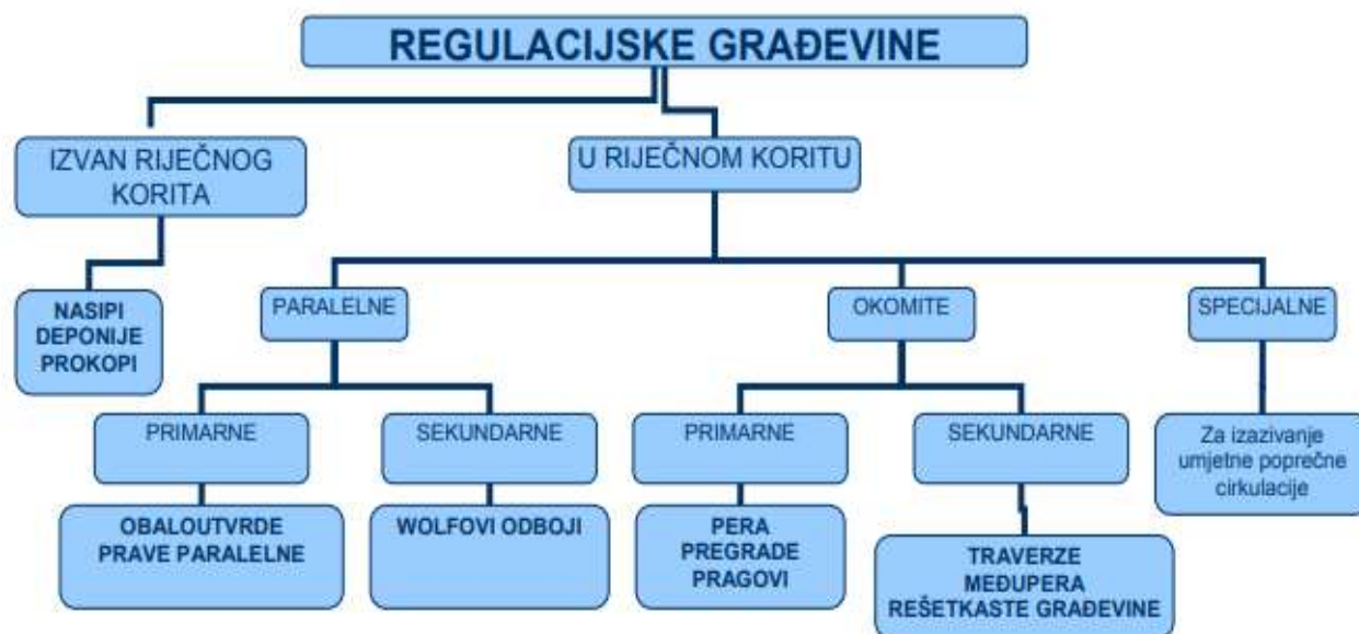
Slika 3. Podjela regulacijskih građevina za obranu od poplava 3
