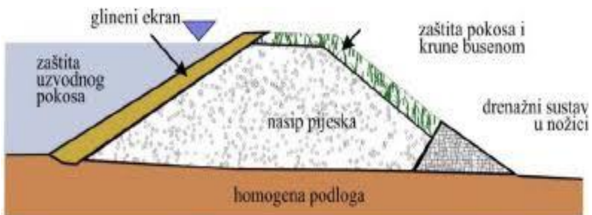
Slika 8. Presjek nasipa s glinenim ekranom.
