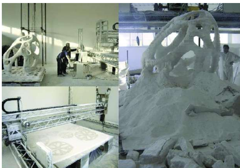
Slika 11. Proces uklanjanja nevezanog materijala
