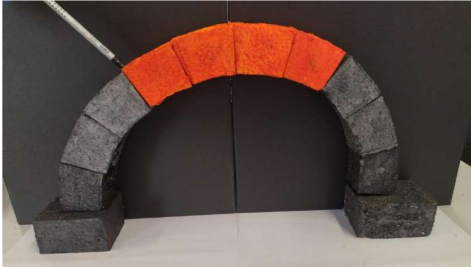
Slika 33. Model luka kad na njega djelujemo koncentriranom silom
