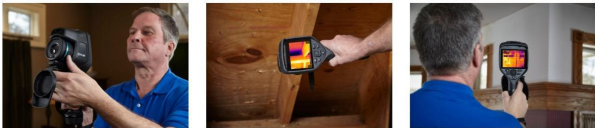
Slika 6. Termografsko snimanje građevnih elemenata od drva
