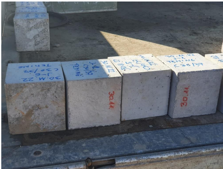
Slika 17. Uzorci za ispitivanje betona s ovog gradilišta
