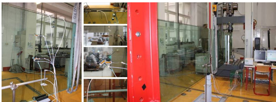
Slika 31 Ispitivanje staklene grede (27)
