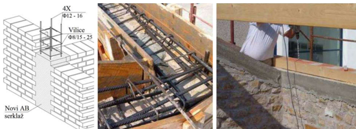
Slika 58. Prikaz izvedbe serklaža od ideje do izvedbe
