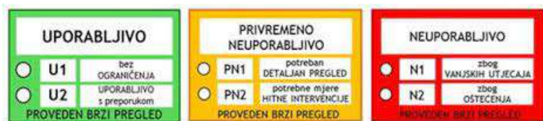
Slika 2 Oznake koje su dodjeljivane tijekom preliminarnog pregleda (Ministarstvo prostornoga uređenja, graditeljstva i državne imovine)
