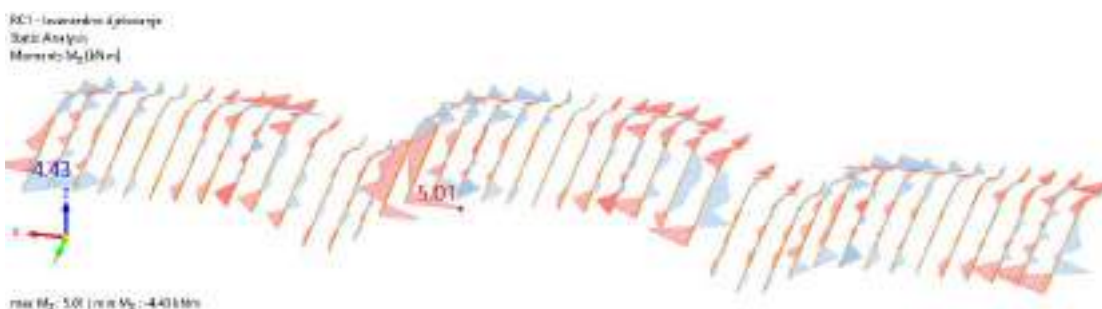
Slika 6.5 Dijagram momenata savijanja M_z [kNm]
