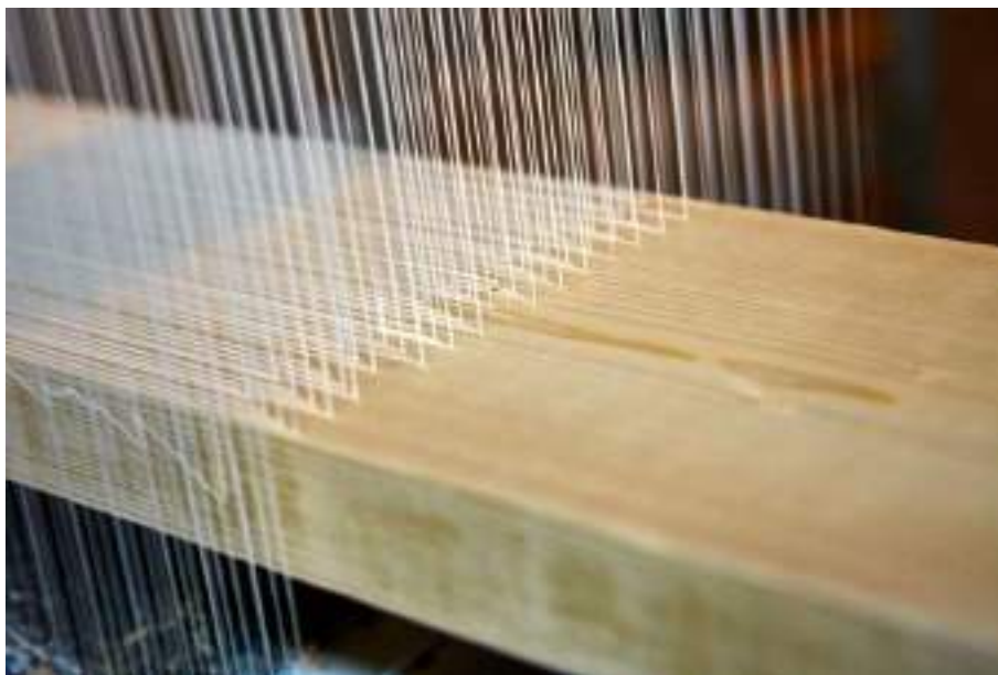
Slika 1.5 Nanošenje ljepila na lamelu [22]
