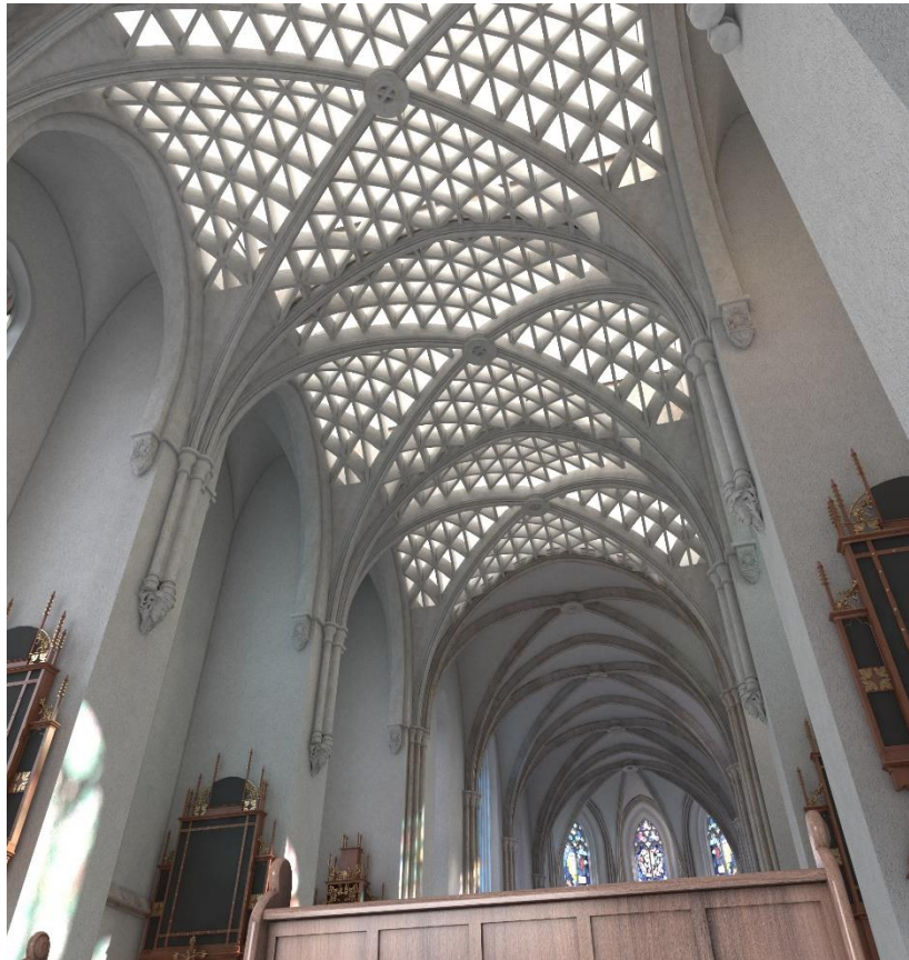
Slika 50. 3D model svoda crkve od lijepljenog lameliranog drva (Prekrtić, 2021)
