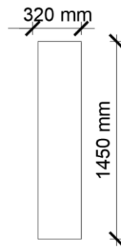
Slika 28. Dimenzije stupa u poprečnom smjeru za određivanje površine na koju djeluje vjetar
