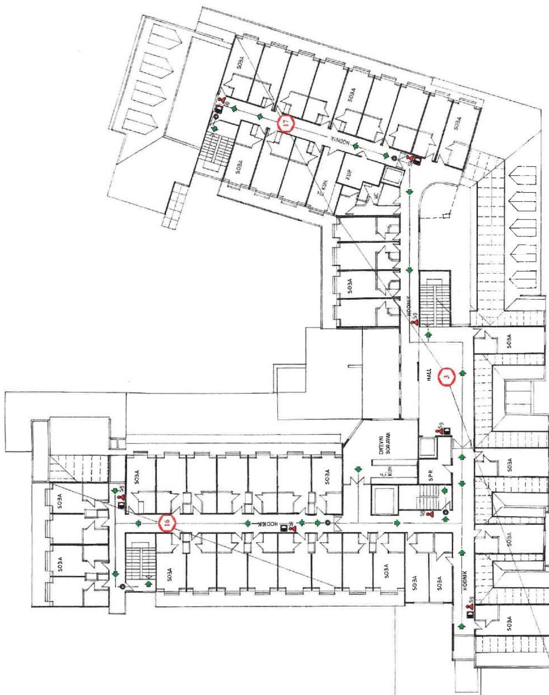
Prilog 5: Požarni odjeljci na 3. katu (45)
