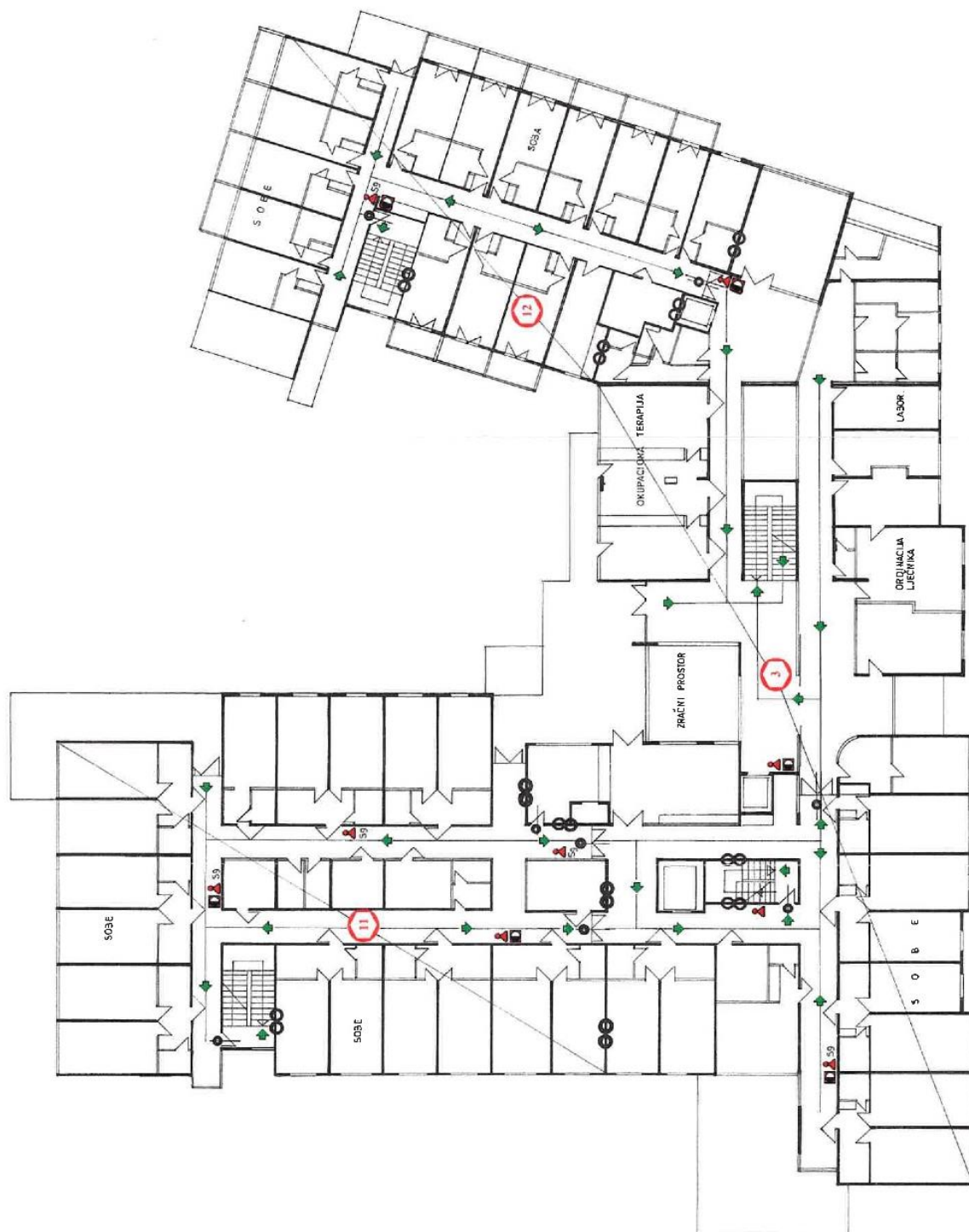
Prilog 3: Požarni odjelci na 1. katu (45)
