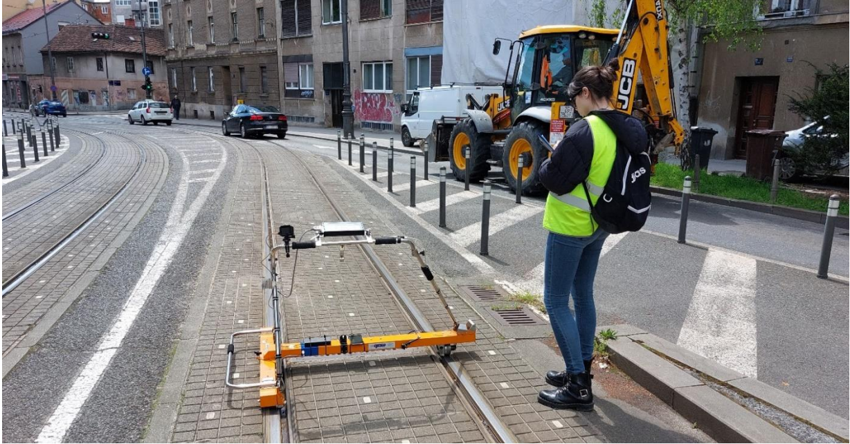
Slika 18. Mjerenje geometrije TEC-1000 ručnim kolicima
