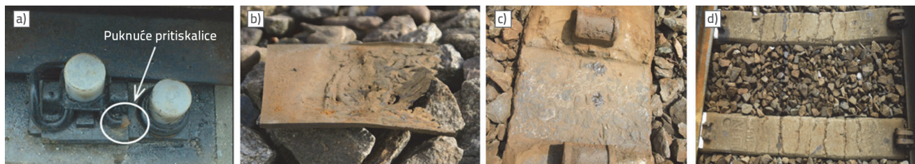
Slika 3. a) Primjer puknuća pritiskalice [10]; b) istrošenje podtračničkog podloška [20]; c) ležajnog mjesta na pragu [24]; d) puknuće betonskih pragova [23]
