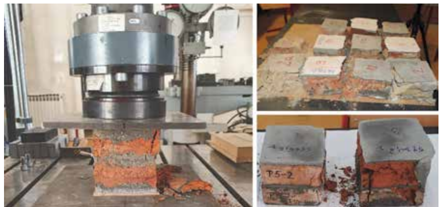
Slika 13. Ispitivanje tlačne čvrstoće opeke i uzorci nakon sloma
