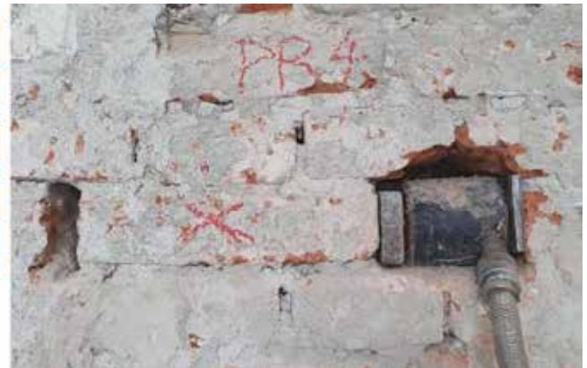
Slika 1. Ispitivanje posmične čvrstoće zida: shematski prikaz (lijevo), provedba ispitivanja (desno)
