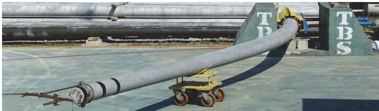
Slika 15. Ispitivanje nosivosti – uzorak 7/8 – pomak neposredno prije sloma
