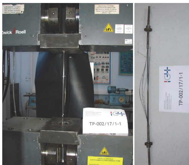
Slika 1. Ispitivanje šipke od polimera armiranog vlaknima [4]
