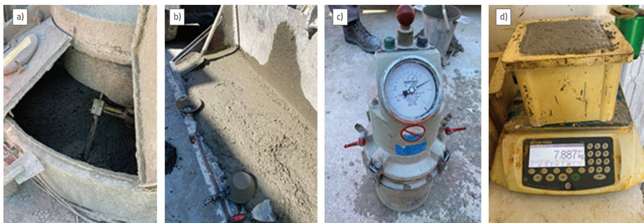
Slika 7. Priprema svježeg betona s recikliranim agregatom: a) svježi beton, b) uzorkovanje, c) ispitivanje udjela pora, d) određivanje gustoće
