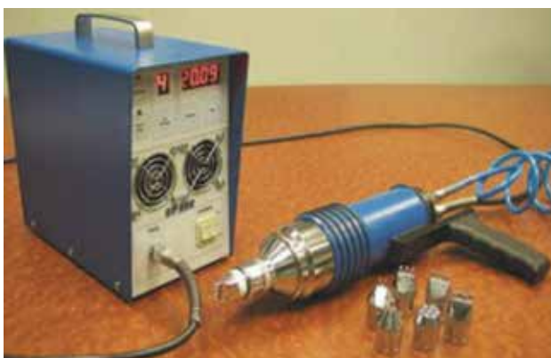
Slika 4. Primjer HFMI uređaja i različitih dostupnih glava [12]
