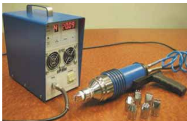
Slika 4. Primjer HFMI uređaja i različitih dostupnih glava [12]
