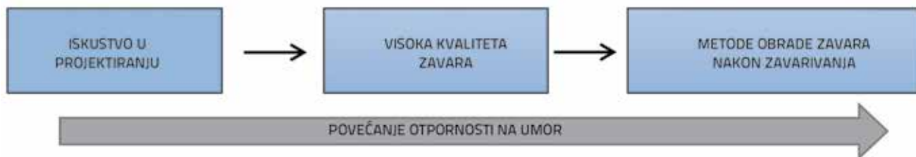
Slika 2. Način postizanja visoke otpornosti na umor
