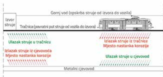
Slika 6. Shematski prikaz nastanka lutajućih struja na tračničkoj infrastrukturi
