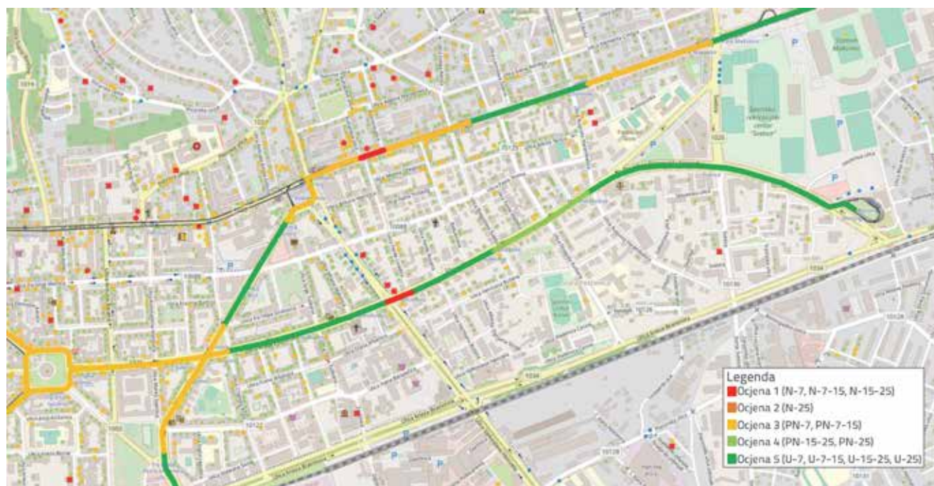
Slika 19. Analiza tramvajске mreže s obzirom na udaljenost kolosijeka i oštećenost zgrada u potresu
