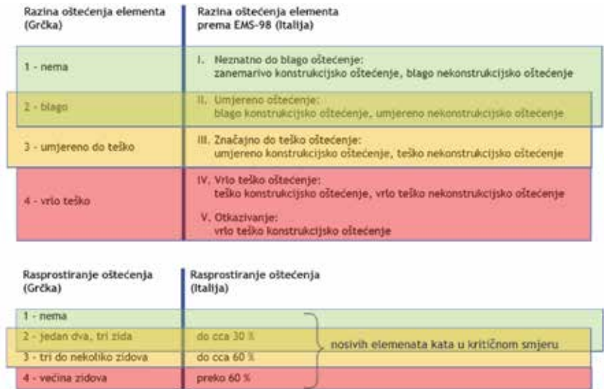
Slika 6. Ocjena oštećenja elemenata – boje prema kategorijama oštećenja iz hrvatskih obrazaca u usporedbi s talijanskim i grčkim kriterijima
