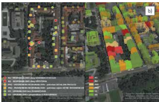
Slika 5. Rezultati procjene uporabljivosti zgrada nakon potresa u Zagrebu u ožujku 2020. godine: a) prikaz oštećenja stambenih i stambeno-poslovnih zgrada prema oznakama uporabljivosti (boje) i bruto razvijenoj površini (visina stupca) na perspektivnom prikazu karte Zagreba; b) uporabljivost zgrada u jednom bloku u Donjem gradu [6]
