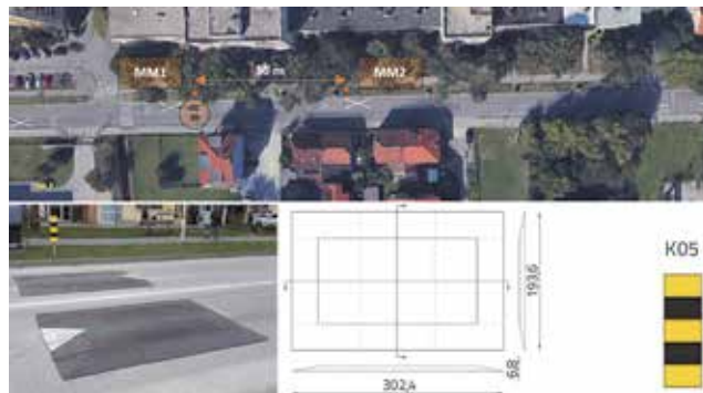
Slika 5. Promatrani dio u Ulici Dragutina Golika i trapezne gumene uzdignute plohe [41]
