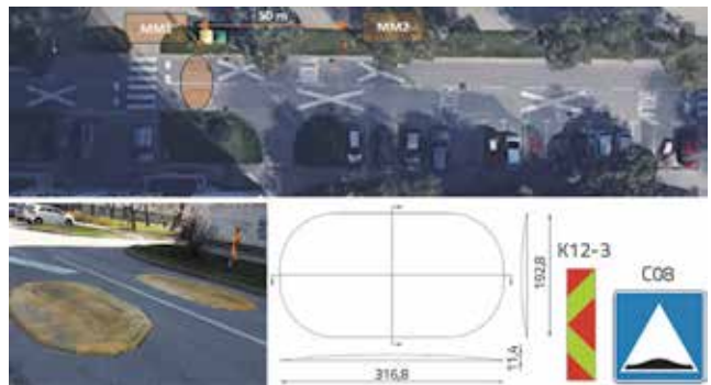
Slika 10. Promatrani dio u Nalješkovićevoj ulici i zaobljene elipsaste betonske umjetne izbočine [41]
