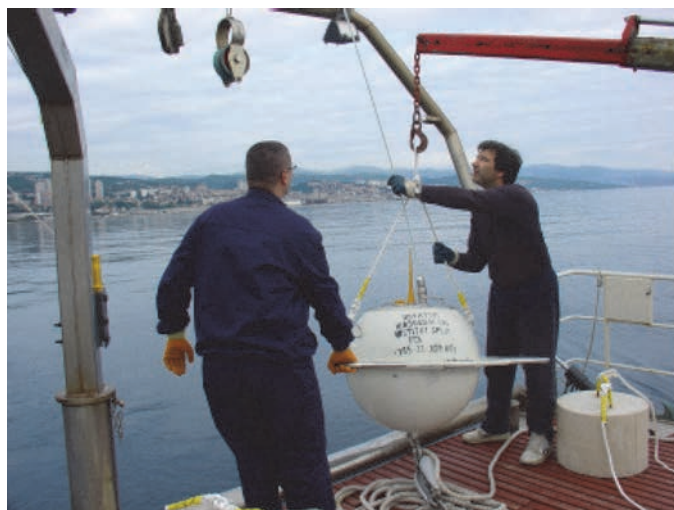
Slika 7. Mjerna plutača Waverider DATAWELL DWR MKIII ispred grada Rijeke u periodu 2009.-2010., postavljanje plutače i izmjereni usmjereni spektar valne energije (u realnom vremenu)
