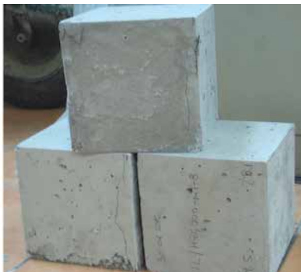
Slika 2. Uzorci jedne mješavine morta (lijevo) i betonske kocke za ispitivanje tlačne čvrstoće i maksimalne dubine prodora vode pod tlakom (desno)
