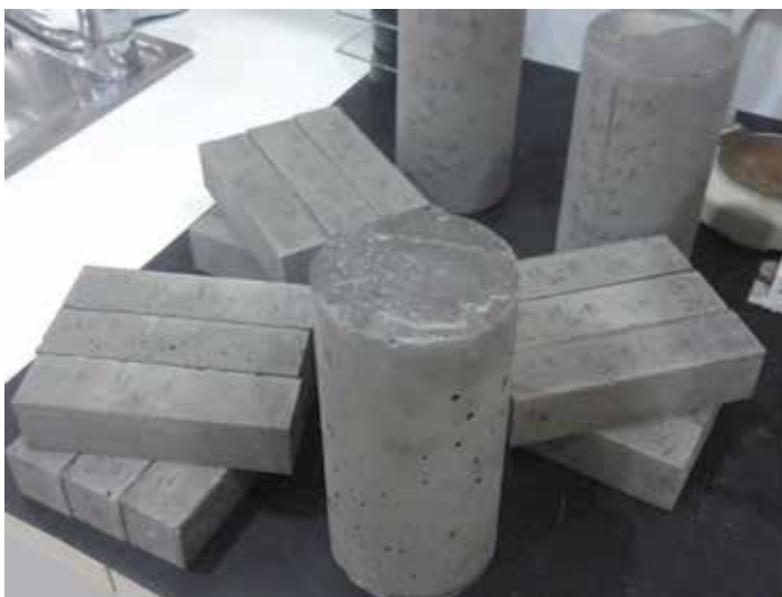
Slika 2. Uzorci jedne mješavine morta (lijevo) i betonske kocke za ispitivanje tlačne čvrstoće i maksimalne dubine prodora vode pod tlakom (desno)
