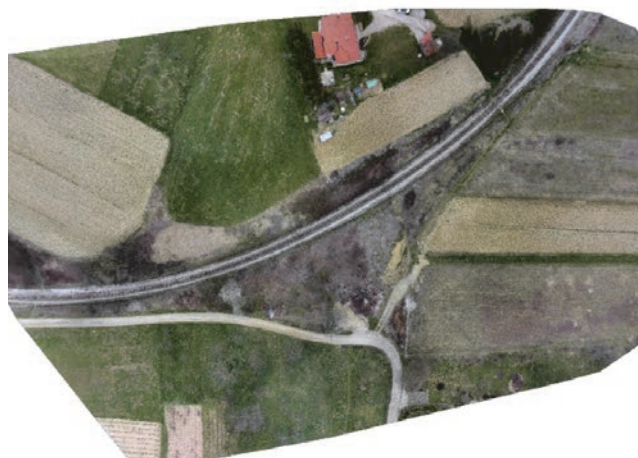
Slika 12. Ortofoto karta iz fotografija snimljenih bespilotnom letjelicom
