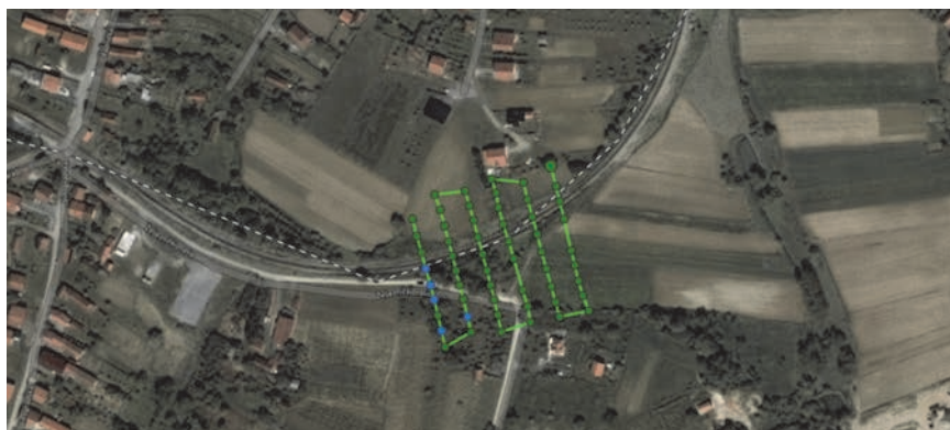
Slika 10. Prikaz leta bespilotne letjelice te pozicija fotografiranja
