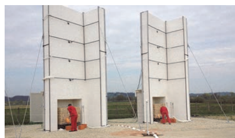
Slika 9. Paljenje konstrukcije od drvenih letvica – početak požara
