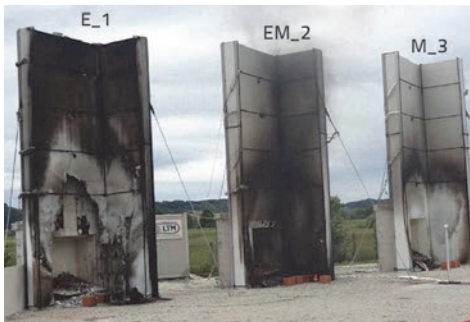
Slika 15. 57 minuta nakon početka – izvor topline je izgorio
