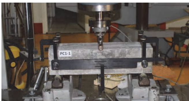
Slika 6. Vlačna čvrstoća na savijanje: a) ispitivanje uzorka prizme; b) dijagram sila - pomak
