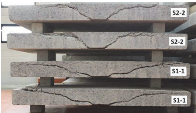
Slika 18. Prerezane ploče S1-1 i S2-2 nakon ispitivanja
