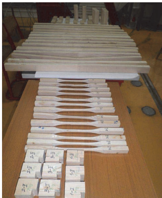
Slika 6. Pripremljeni mali uzorci za ispitivanje
