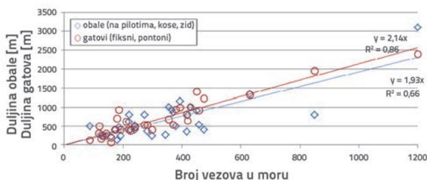
Slika 4. Prikaz izmjerenih duljina izgrađenih obala, fiksnih gatova i pontona u funkciji broja vezova u moru [4, 5]
