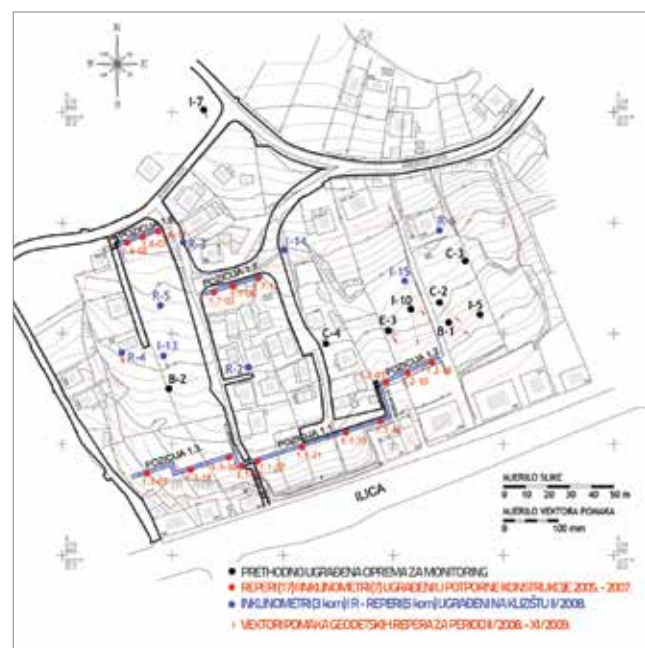
Slika 15. Klizište Grmošćica, mjerna oprema ugrađena za vrijeme i nakon sanacije
