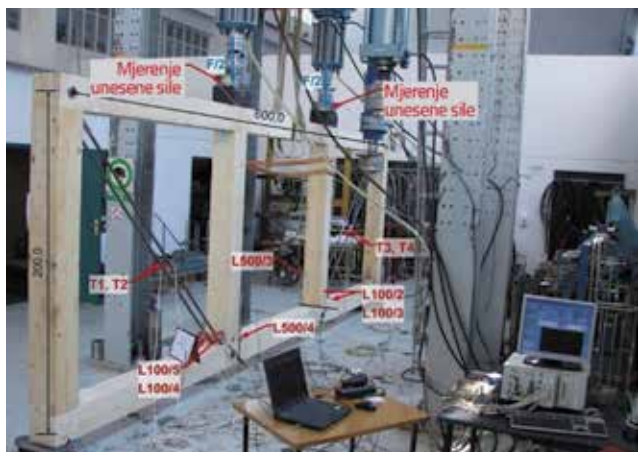
Slika 2. Eksperimentalna ispitivanja rešetki
