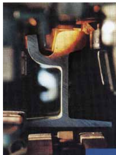
Slika 2. Termička obrada glave žljebaste tračnice
