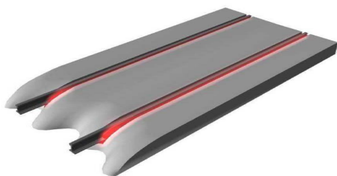
Slika 19. Shematski prikaz kolosijeka s elastično obloženim tračnicama
