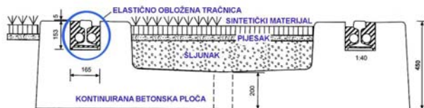
Slika 20. Poprečni presjek kolosiječnog sustava „INFUNDO“ [1]
