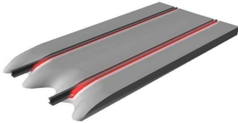
Slika 19. Shematski prikaz kolosijeka s elastično obloženim tračnicama
