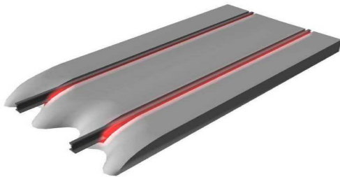
Slika 19. Shematski prikaz kolosijeka s elastično obloženim tračnicama
