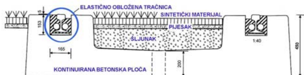
Slika 20. Poprečni presjek kolosiječnog sustava „INFUNDO“ [1]
