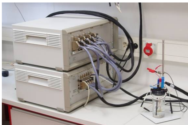
Slika 4. Sustav za elektrokemijska ispitivanja korozijske otpornosti
