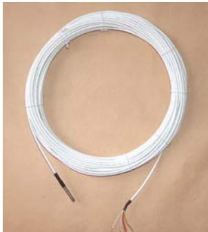
Slika 2. Pt-100 sonda za mjerenje temperature
