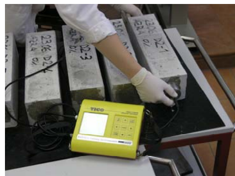
Slika 5. Određivanje dinamičkog modula elastičnosti
