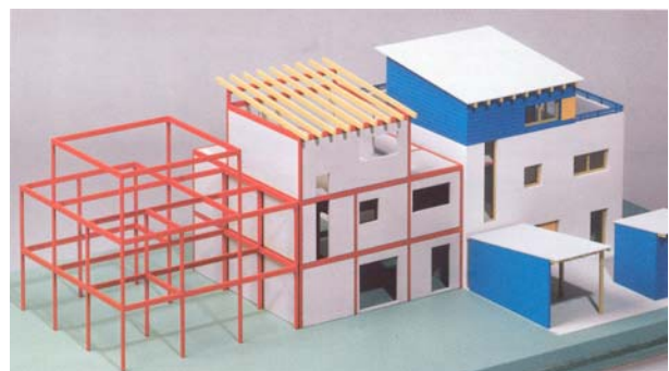
Slika 7. Faze izvedbe kuće u sustavu okvirne gradnje
