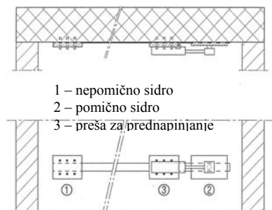
Slika 10. Sustav prednapinjanja. Nepomično pomično sidro i preša [19]
