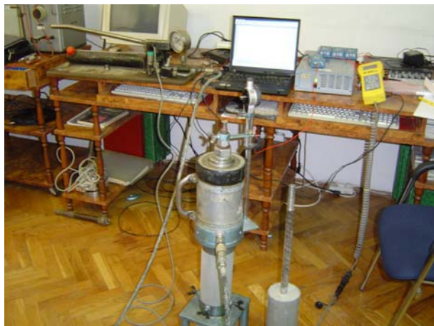
Slika 4. Oprema za izvođenje pokusa čupanja u laboratoriju [3]
