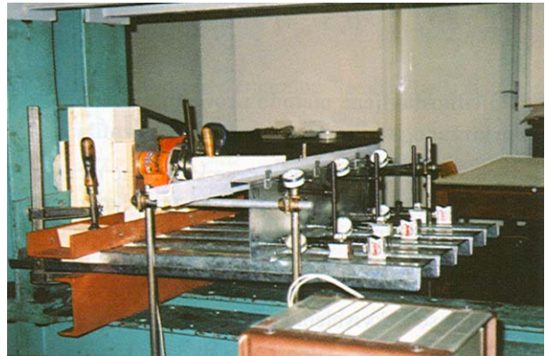
Slika 10. Eksperimentalno određivanje stupnja bočne (torzijske) krutosti
