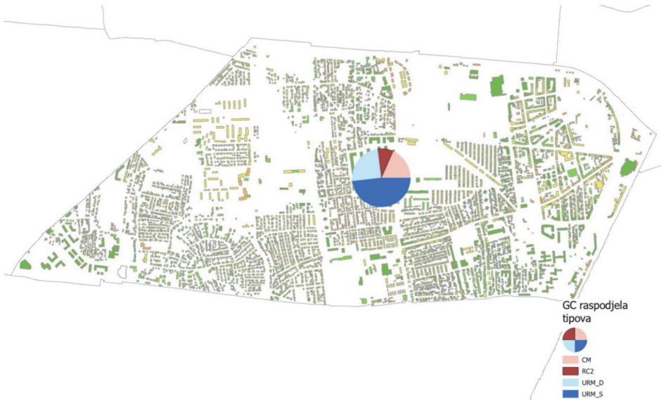
Slika 4. Trešnjevka sjever s udjelima tipova zgrada
