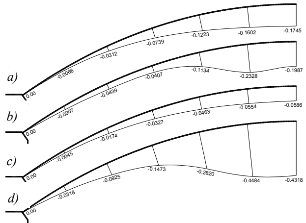
Slika 15. Progibi luka u m: a) od težine luka, b) od težine grede - konačno stanje c) od puzanja betona, d) ukupni progibi
