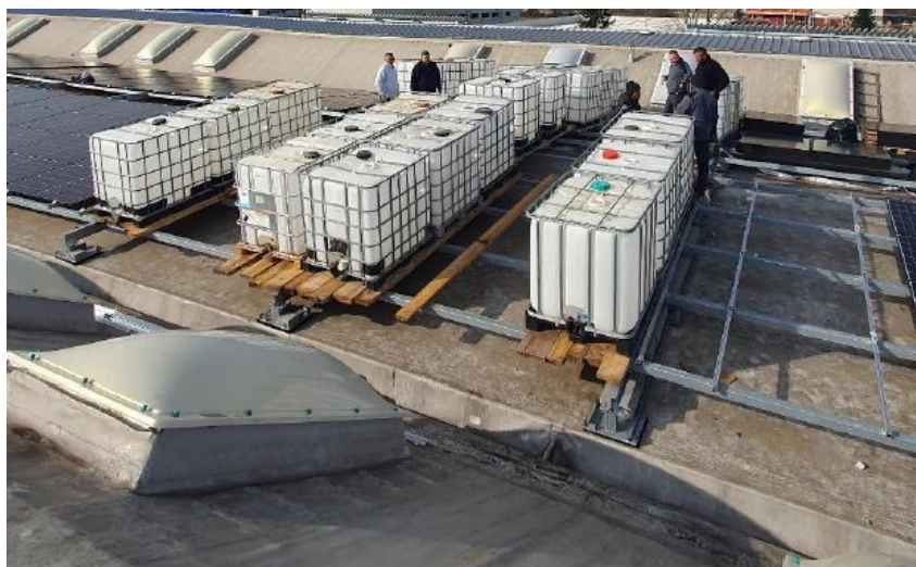
Slika 7.10 Prazni spremnici (ukupno 26 kom) namješteni prema rasporedu (prije ispitivanja)
