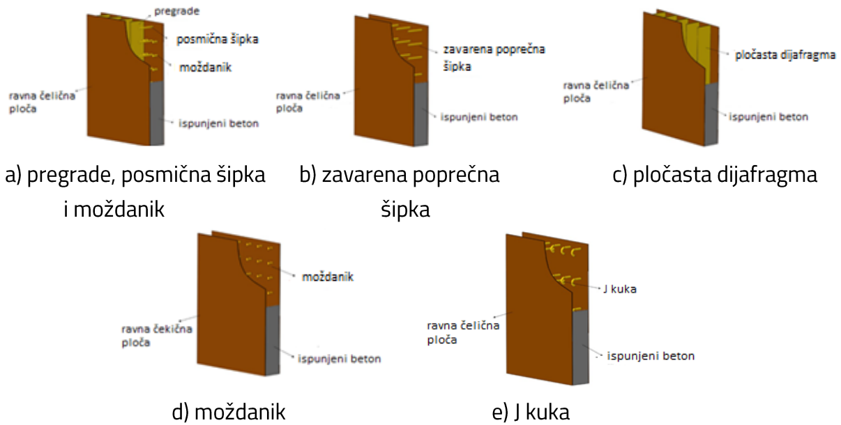
Slika 3.10. Ravna čelična ploča CFCSW s različitim vrstama spojnih sredstava [4]
