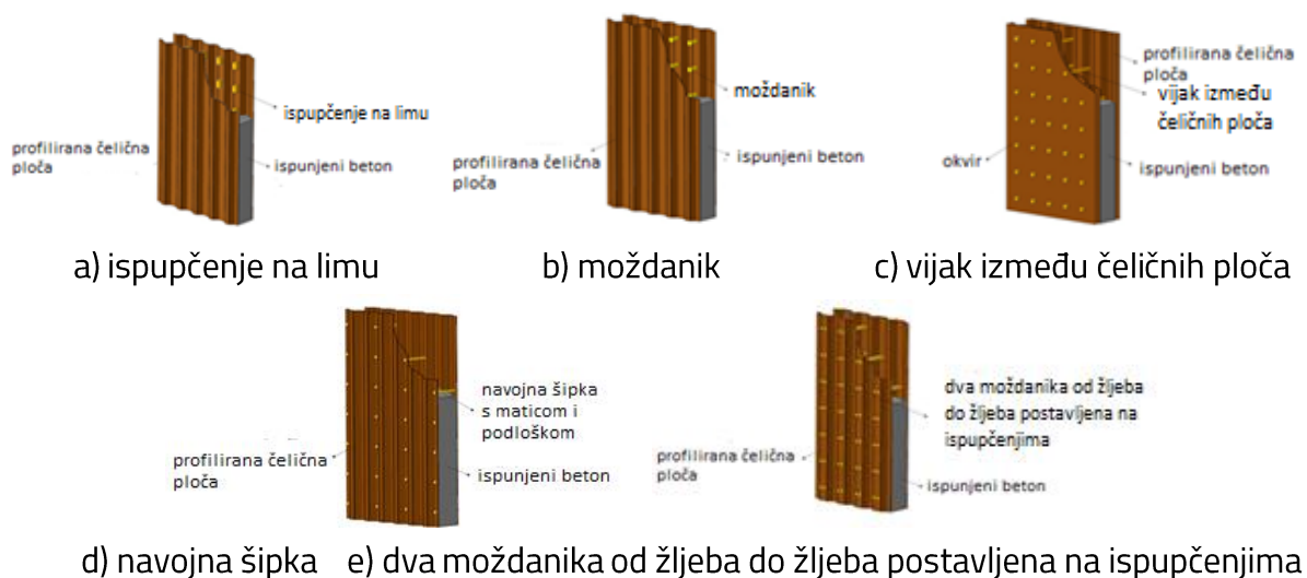
Slika 3.9. Profilirana čelična ploča CFCSW s različitim vrstama spojnih sredstava [4]
