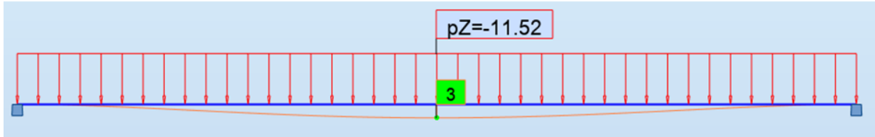
Slika 10.9. Progib tijekom izvedbe za sveukupno opterećenje
