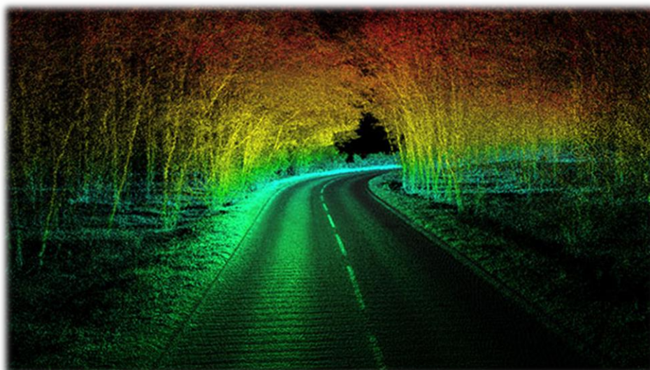
Slika 4. Prikaz oblaka točaka registriranih pomoću LiDAR senzora [20]
