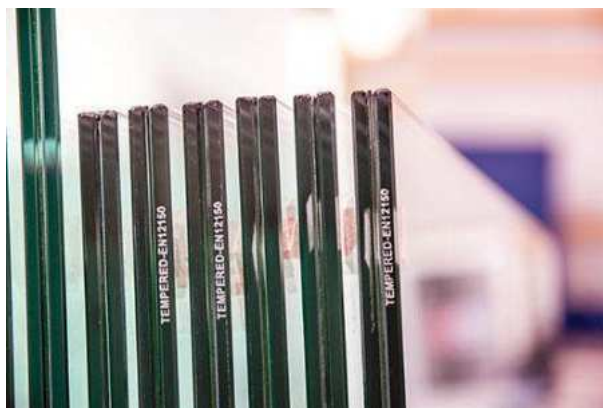
Slika 11: Laminirano staklo (Izvor: [22])
