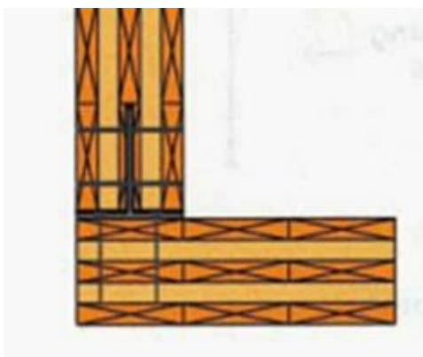
Slika 25.: Povezivanje CLT zidova utisnutim limom (Izvor: [38])
