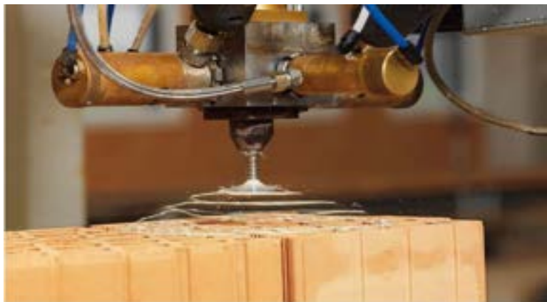
Slika 8.: Strojno nanošenje dvokomponentnog ljepila (Izvor: [12])
