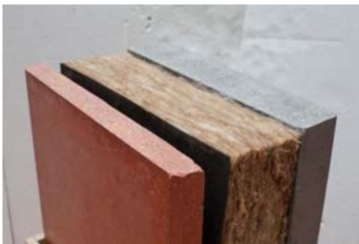
Slika 5.: Troslojni sendvič panel (Izvor: [7])
