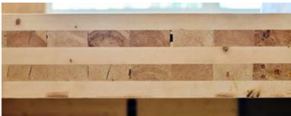
Slika 15.: Slojevi križno lameliranog drva (Izvor: [22])
