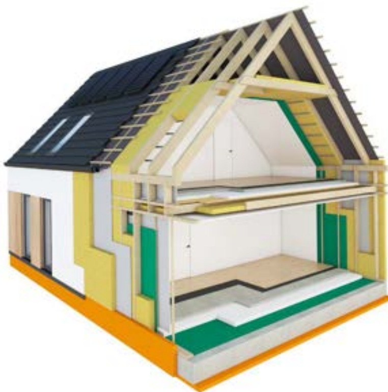
Slika 20.: Slojevi zida s KVH konstruktivnim elementom (Izvor: [31])
