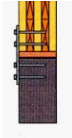
Slika 31.: Spajanje montažnog zida s betonskim temeljem (Izvor: [38])
