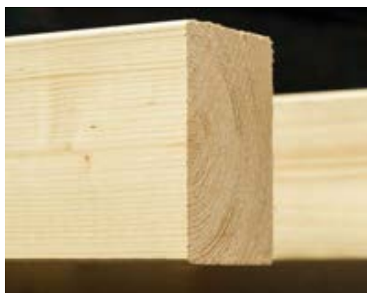
Slika 19.: KVH greda (Izvor: [29])
