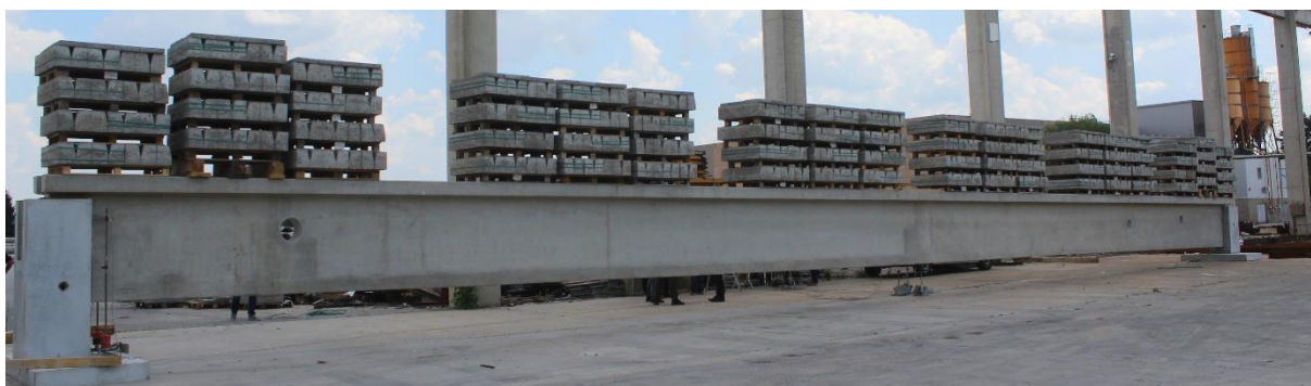
Slika 8.7.2. Opterećenje nosača u fazi 3
