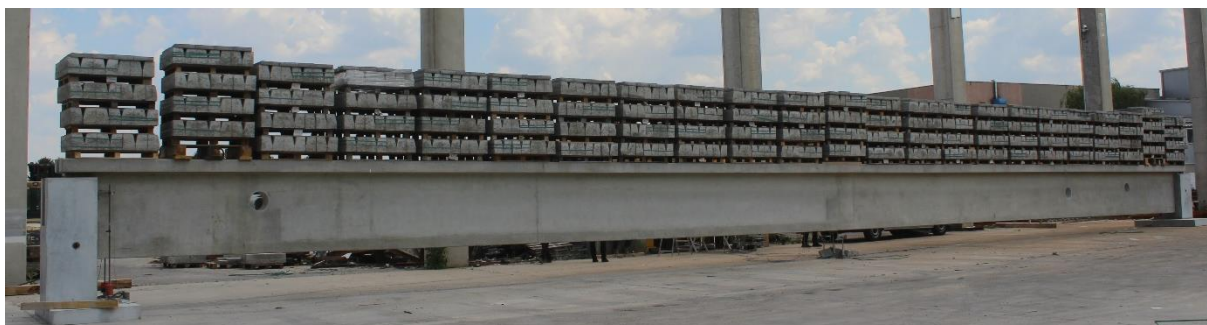
Slika 8.7.3. Opterećenje nosača u fazi 4
