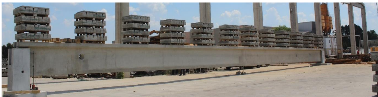
Slika 8.7.1. Opterećenje nosača u fazi 2
