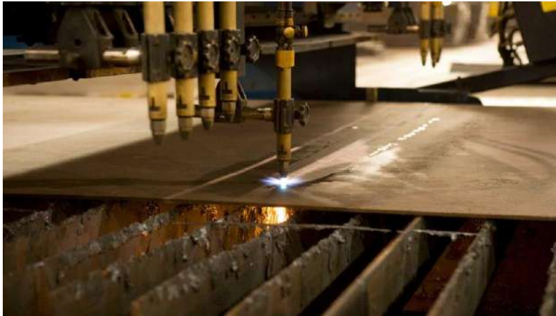
Slika 23: Termalno rezanje čelične ploče
